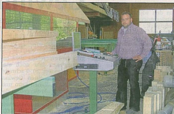
Hightech: Geschäftsführer Marcel Sander an der Schaltanlage einer Abbundanlage. Sie kann millimetergenau auf Länge schneiden, bohren und fräsen.
